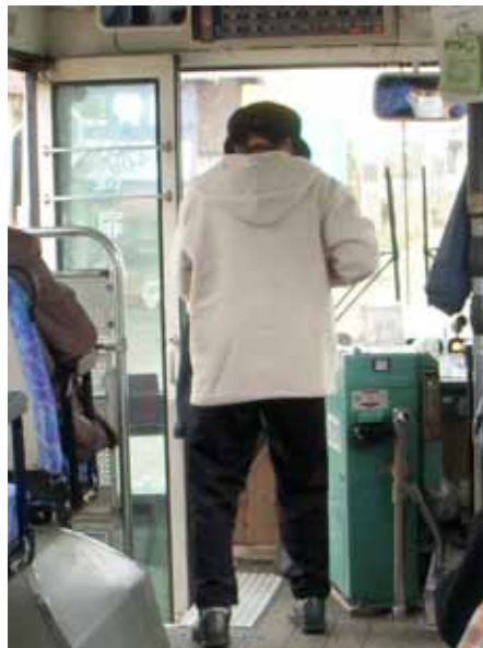
料金徴収をしやすい様に通路幅を狭めているワンマンバスの降り口 One-man (conductorless) bus door, with narrow aisles to make the collection of fees easier
